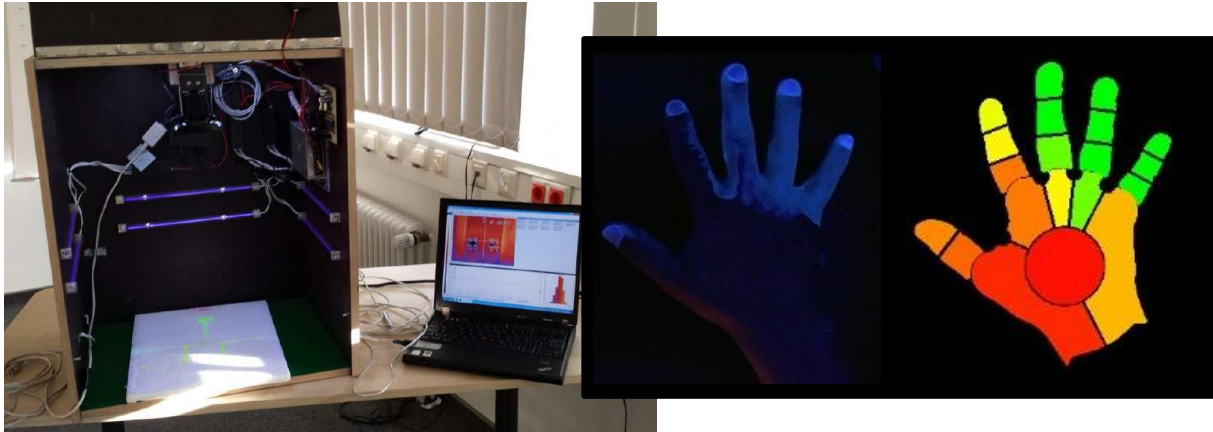
HARDWAREAUFBAU (LINKS) UND AUFNAHMEN UNTER UV-LICHT MIT ENTSPRECHENDEM ERGEBNISBILD (RECHTS)
